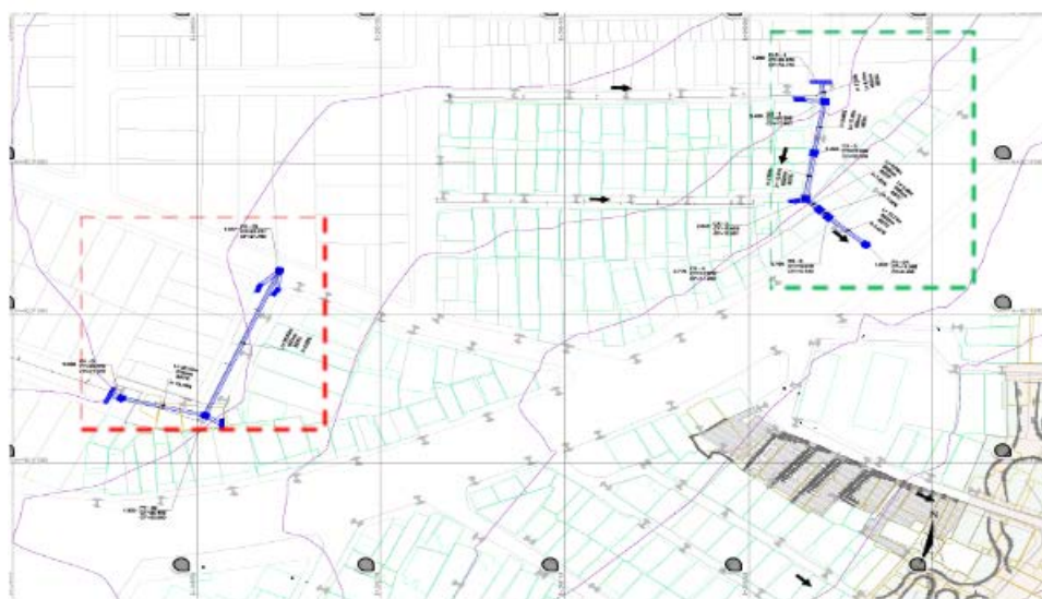
Figura 41 - Projeto de Drenagem Pluvial – 1ª Parte do projeto de Drenagem Pluvial (em vermelho) e 2ª Parte do projeto de Drenagem Pluvial (em verde).
