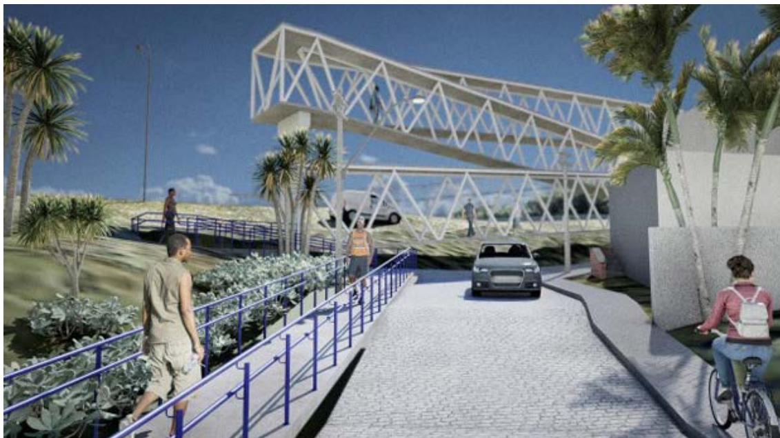
Figura 25 - Vista do trecho final da via, com a interligação à passarela por meio de rampa ao longo do passeio público.
