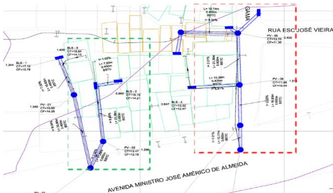
Figura 54 - Projeto de Drenagem Pluvial.
