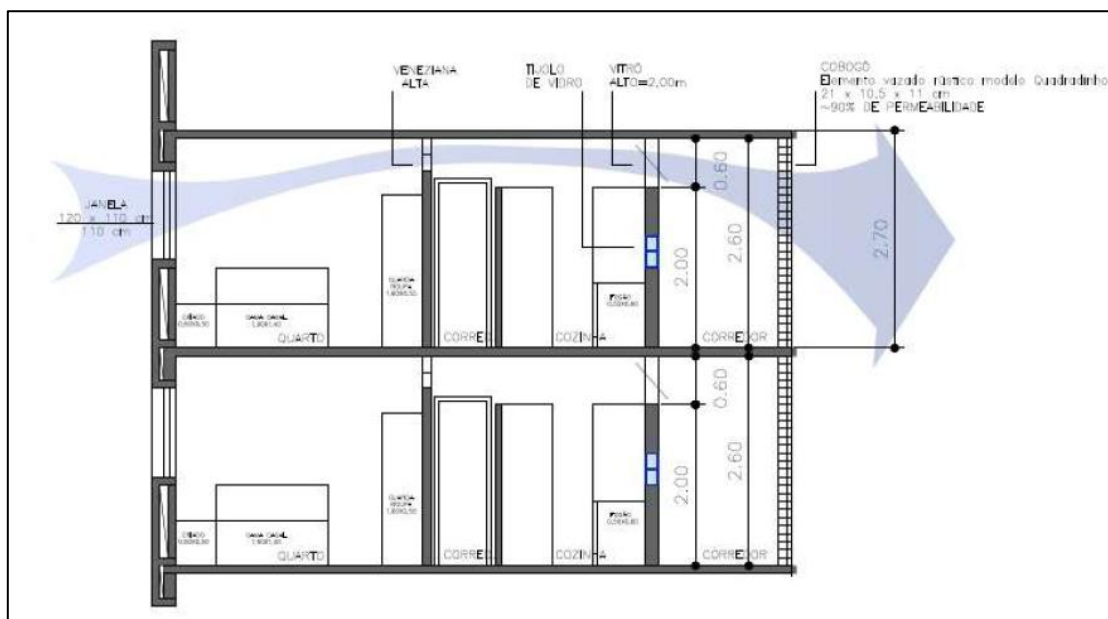
Figura 11 - Corte esquemático planta tipo simulação de passagem de ar
