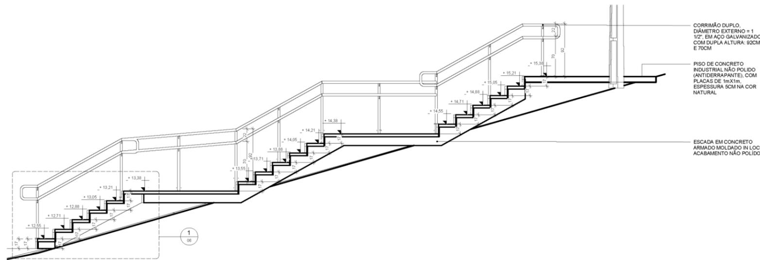
CORRIMÃO DUPLO, DIÂMETRO EXTERNO = 1 1/2", EM AÇO GALVANIZADO, COM DUPLA ALTURA: 92CM E 70CM
