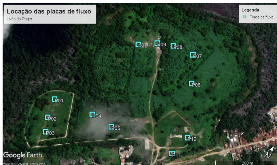
Figura 3.5 – Locação dos ensaios de placa de fluxo.
