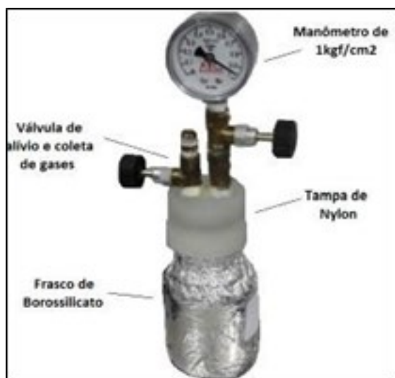
Figura 4.7 – Biorreatores utilizados em ensaios BMP
