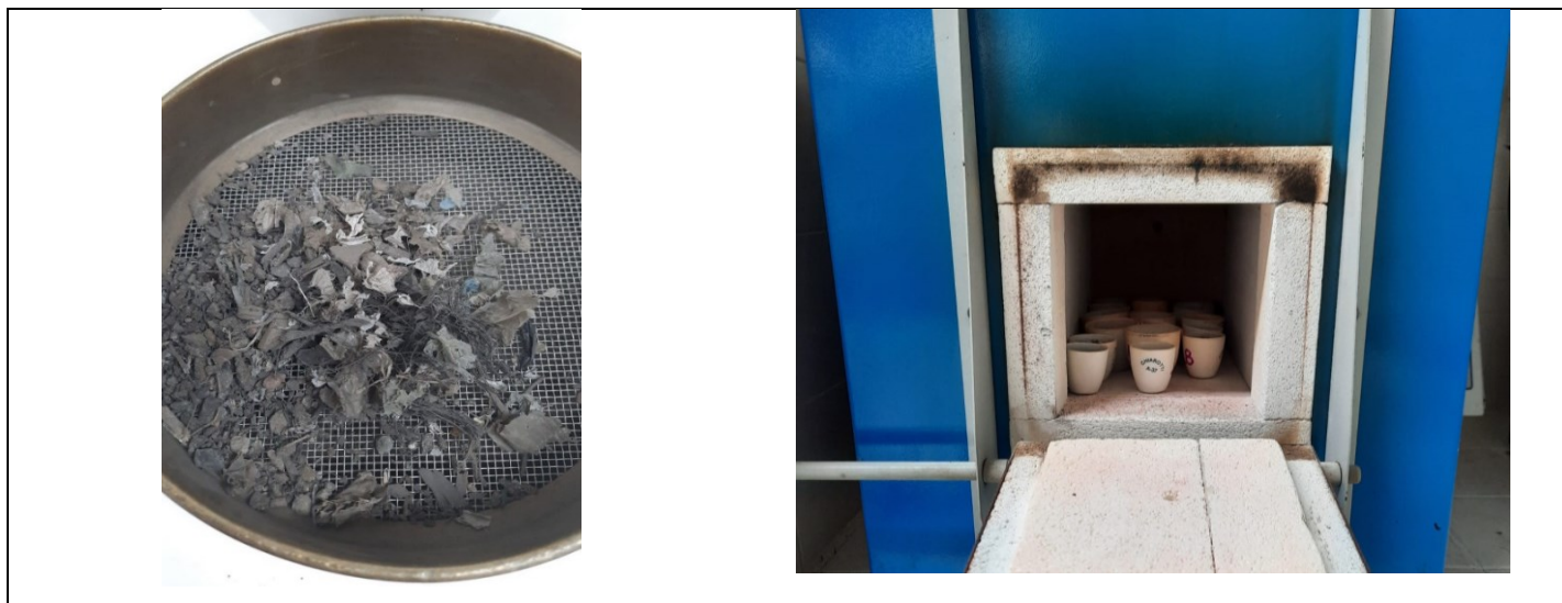
Figura 4.4 – Ensaio de Sólidos Voláteis - Preparação da amostra para calcinação
