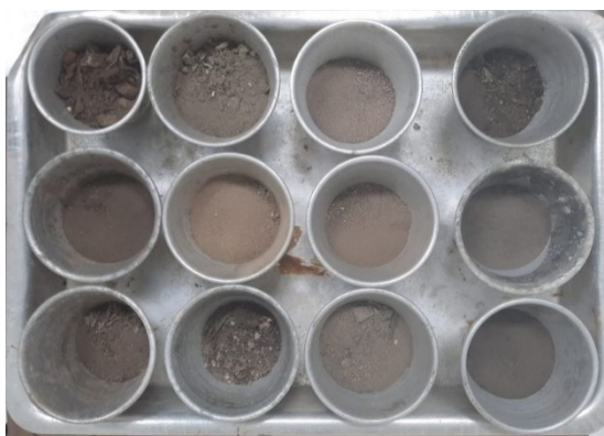
Figura 4.2 – Amostras após ensaio de umidade - verificada a estabilização
