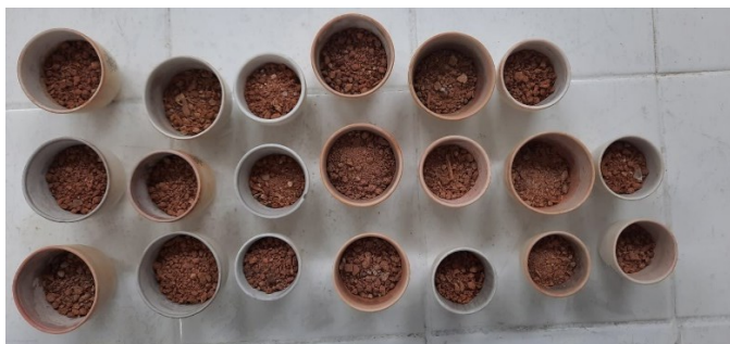
Figura 4.5 – Amostras após calcinação na mufla
