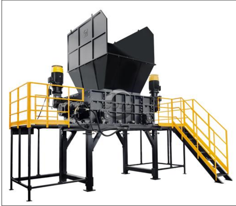
Figura 6.7 – Triturador primário de 4 eixos para resíduos
