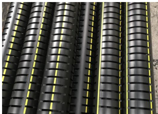
Figura 4.15 – Exemplo de Tubo PEAD ranhurado para drenagem de biogás
