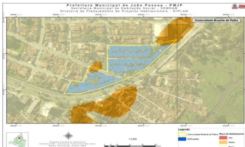
Figura 5- Mapa de deslizamentos da Comunidade Brasília de Palha.
